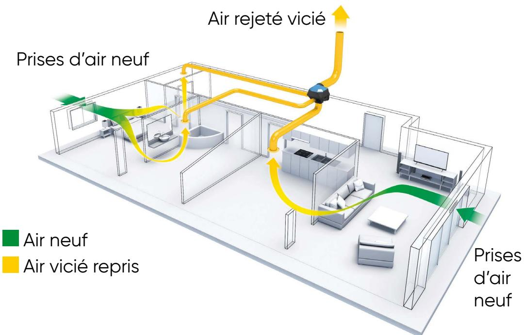
La Ventilation Mécanique Contrôlée (VMC) simple flux fonctionne avec plusieurs entrées d'air présentes dans vos pièces sèches (salon et chambres). Ensuite L'air vicié (pollué) est récupéré dans les pièces humides (salle de bain, toilette et cuisine) grâce à des bouches d'extraction et il est rejeté hors du logement. C'est le principe du balayage de l'air dans votre logement.
